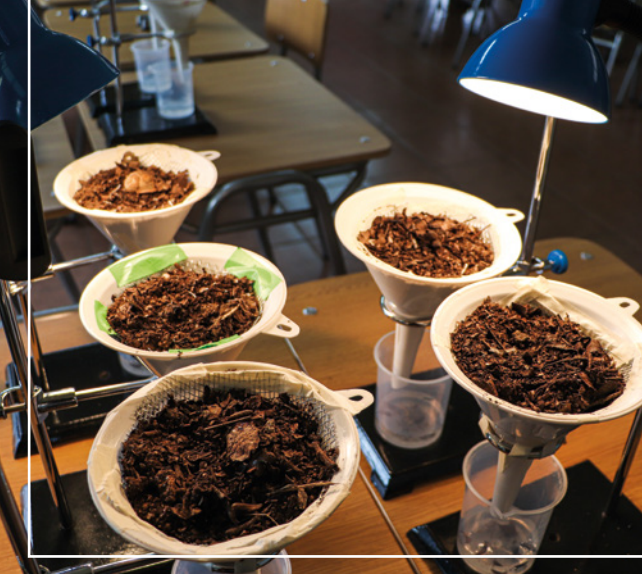
Figura 16. Ejemplo de embudo de Berlese-Tullgren conteniendo muestras de suelo obtenidas de jardín y trabajo de estudiantes.
